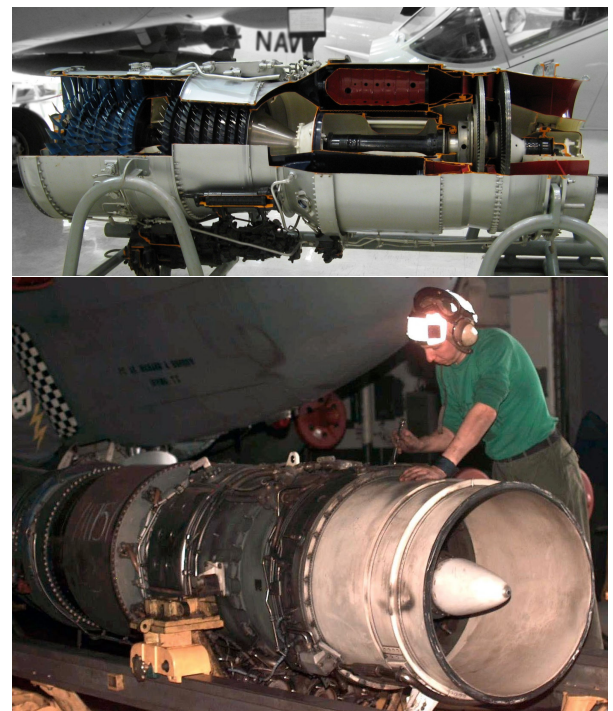
FIGURE 10.35 – Un turboréacteur à simple flux et deux arbres Pratt & Whitney J52 (ou JT8A), construit en 4 500 exemplaires. Il équipe encore le EA-6B Prowler .
