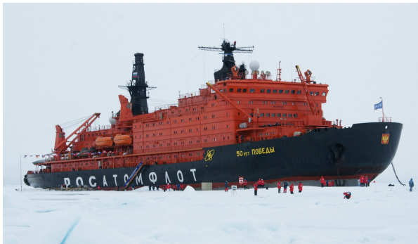
FIGURE 9.28 – Le 50 Let PODEBY, brise-glace de 25\,000\text{ t} à propulsion nucléo-turbo-électrique (deux réacteurs de 171\text{ MW}_{\text{chaleur}} , trois moteurs de 17,6\text{ MW}_{\text{méch.}} ). Sa construction a débuté en 1989 mais il n'est entré en service qu'en 2007.
