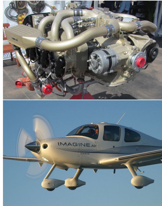
FIGURE 10.31 – Moteur six cylindres essence à injection Continental IO-550 de 300 ch, en fabrication depuis 1983. Il équipe entre autres l'avion Cirrus SR22 . Cette photo montre la version turbocompressée du moteur, dont on aperçoit l'intercooler en haut à gauche.
