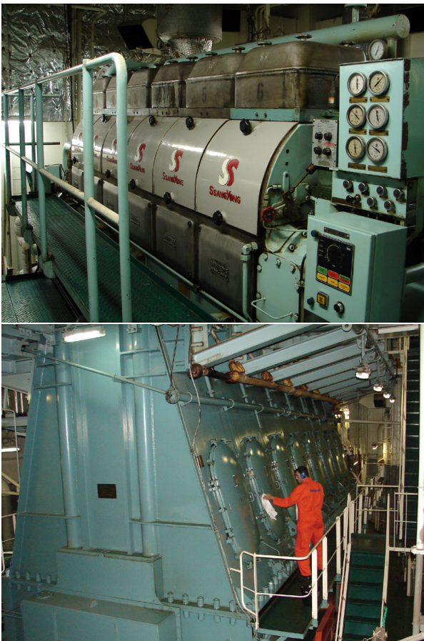
FIGURE 10.32 – Moteurs Diesel six cylindres de 1 100 kW électrogène (gauche) et sept cylindres de 25 MW propulsif (droite) d'un pétrolier de 290 000 t.
