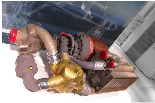
FIGURE 6.23 – Un ECS destiné à un Comac C919, de longueur environ 1,5 m.
