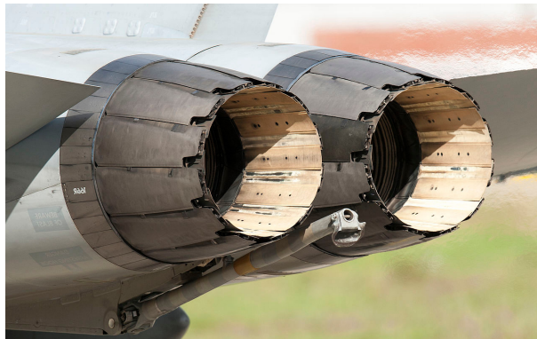
FIGURE 10.14 – Les tuyères de deux General Electric F404 équipant un avion de combat. La géométrie de la tuyère, d'importance capitale en mécanique des fluides, n'est pas abordée dans cet ouvrage.
