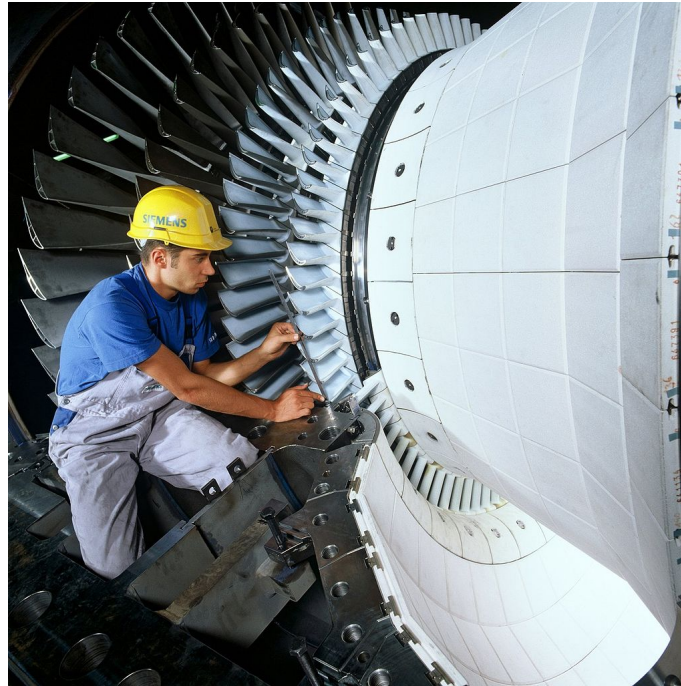
FIGURE 10.12 – Turbine d'un turbomoteur générateur. La turbine photographiée, une Siemens SGT5 , peut accepter un débit d'air et d'eau de 690 \text{ kg s}^{-1} . Elle transmet une puissance à l'arbre d'environ 500 \text{ MW} .
