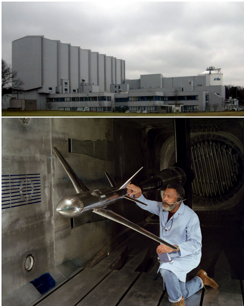
FIGURE 6.20 – Bâtiments de l'ETW ( European Transonic Windtunnel ) à Köln et veine d'essais de la National Transonic Facility de la NASA, de taille et capacités similaires.
